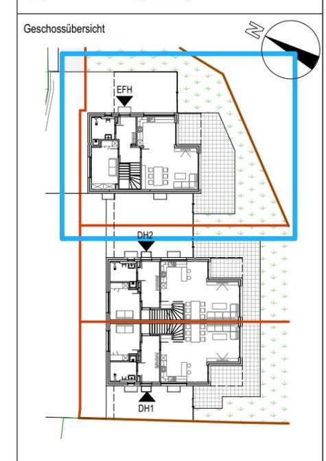
Alle öffentbare Fenster sind Drehkippenster, restliche Fenster sind fixverglast. Dargestellte Einrichtungsgegenstände sind unverbindliche Vorschläge, zulässige Bautoleranzen sind möglich, Planmaße sind Rohbaumaße.
