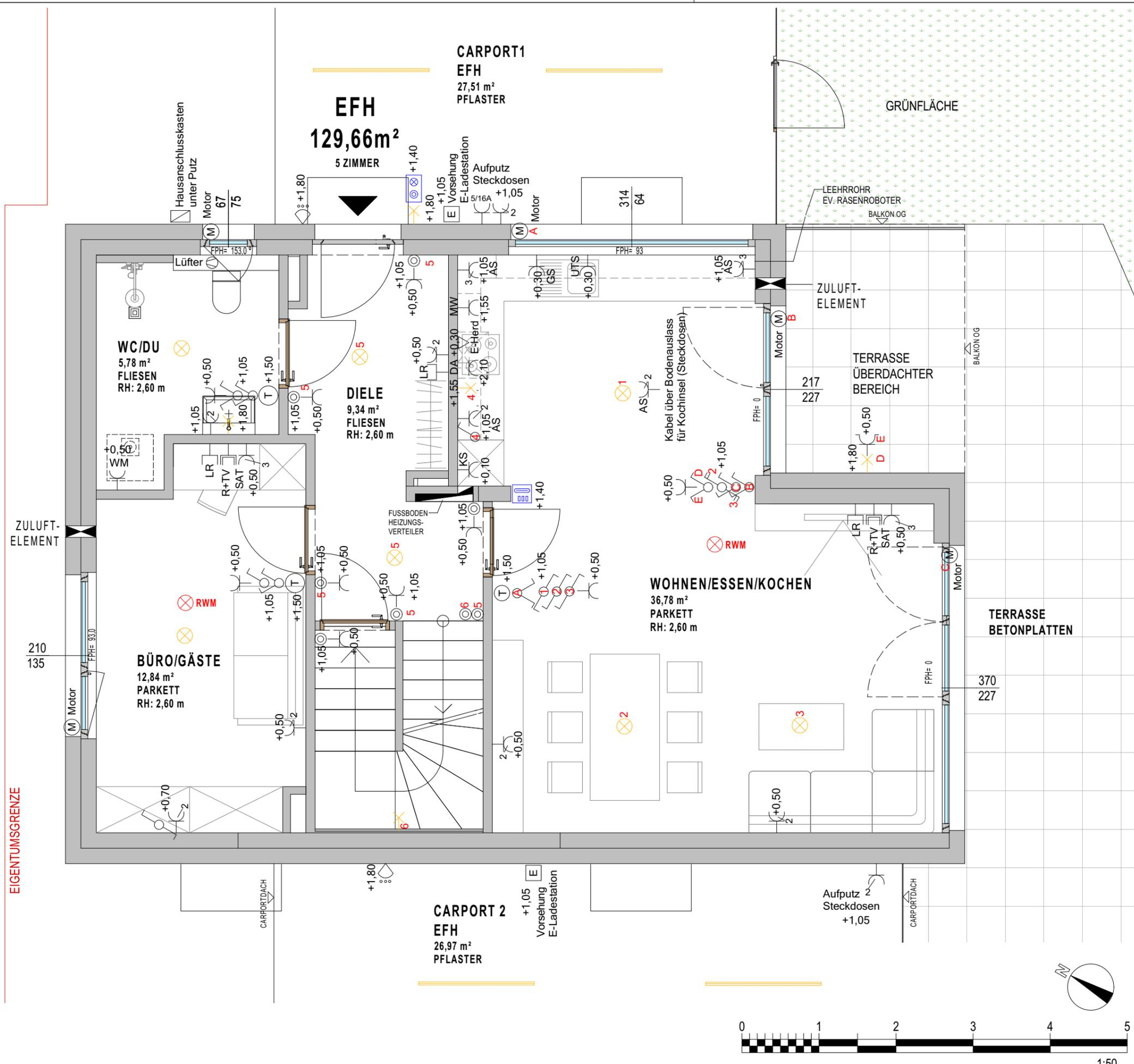
Alle öffentbare Fenster sind Drehkippenster, restliche Fenster sind fixverglast. Dargestellte Einrichtungsgegenstände sind unverbindliche Vorschläge, zulässige Bautoleranzen sind möglich, Planmaße sind Rohbaumaße.
